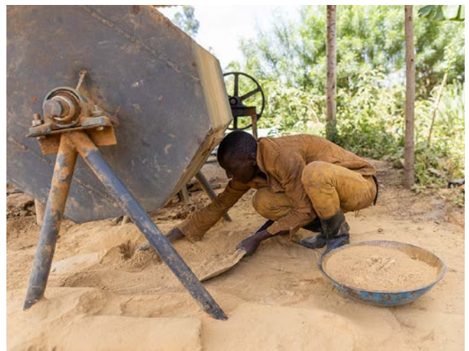
25 Minuten später haben schwere Stahlkugeln die Steine zu feinem Sand verwandelt.
